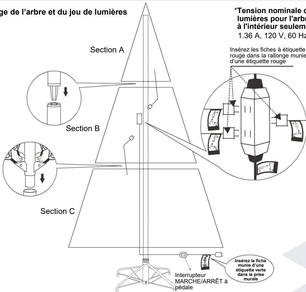
3. Chaque section de l'arbre porte un autocollant numéroté. Veuillez identifier toutes les sections avant l'assemblage.
