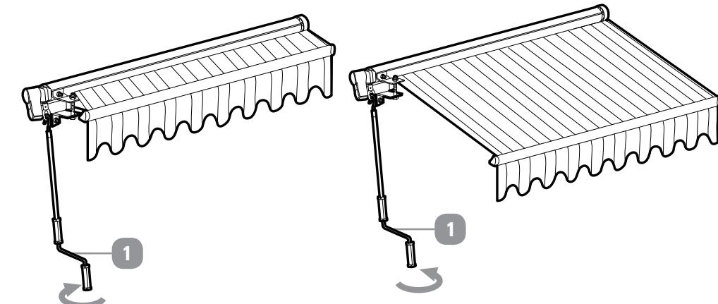
**Reamrque :** Il est recommandé de retirer la manivelle de son réceptacle et de la ranger dans un endroit sécuritaire lorsque vous ne l'utilisez pas.
