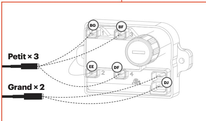
⚠ S'ils ne sont pas visibles, les fils d'électrodes **BG, BF et DF** se trouvent derrière le panneau de commande.
