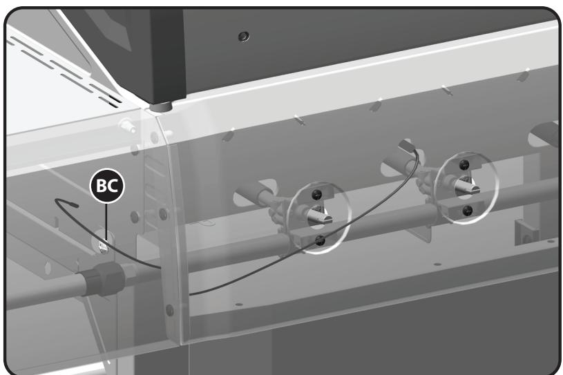
**Attention:** Alimentez le fil d'électrodes du brûleur principal (BC) à travers le trou sur le côté gauche de compartiment des brûleurs près de l'ensemble de tubulures.
