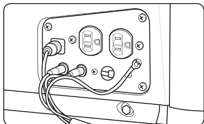
8. Démarrer le moteur des deux onduleurs selon le guide d'utilisation de l'onduleur. Observer le voyant indicateur de sortie vert sur les deux panneaux des génératrices. Le voyant clignotera lors du démarrage. Lorsque le voyant est stable, vous pouvez connecter les appareils.
