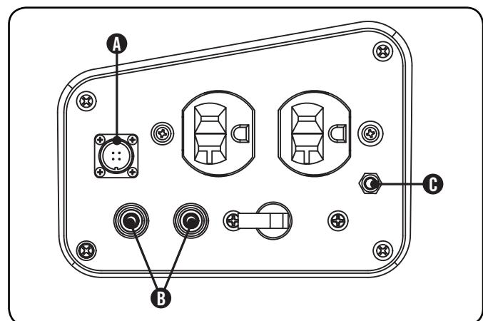
6. Brancher l'autre paire de fils d'alimentation (B), du câble de communication (A) et du fil de mise à la terre (C) au deuxième onduleur.
