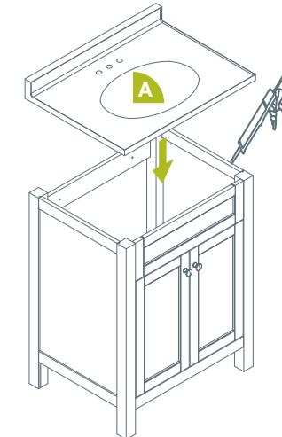
Connecter le bassin et la vanité avec scellant en silicone pour bainet tuiles.
