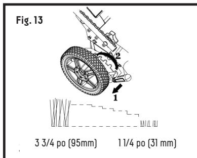
La hauteur de la coupe est réglée de manière centralisée à l'aide de la poignée de réglage de la hauteur. Différentes hauteurs de coupe peuvent être choisies.
