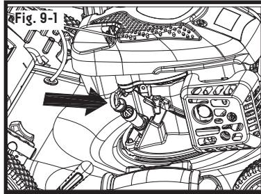
3. Insérez la jauge et vérifiez le niveau d'huile: le niveau d'huile doit être compris entre les repères min. et max. sur la jauge. Si l'huile est au niveau inférieur, remplissez le réservoir d'huile jusqu'au niveau supérieur avec de l'huile recommandée (SAE30 ou équivalent). Ne mettez pas trop d'huile. Essuyez toute huile renversée (voir figure 10).
