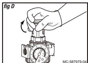
2. Tournez le bouton dans le sens contraire au sens des aiguilles d'une montre jusqu'à ce que la pression ne soit pas appliquée sur le ressort de régulation (fig C).
