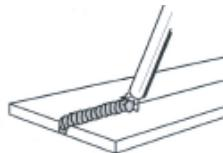
La position horizontale est exécutée de manière très semblable à la soudure plate, mis à part l'angle qui est formé de manière à ce que l'électrode, et donc la force de l'arc, soit dirigée vers le métal au-dessus de joint de soudure.
