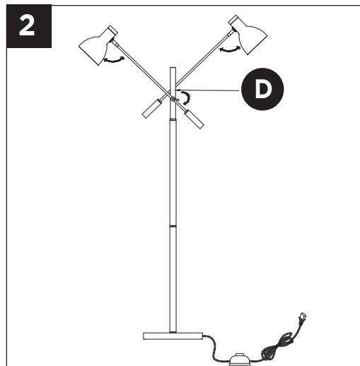
3. Installez les ampoules. Utilisez deux ampoules de type A de 60 W max. (non comprises).
