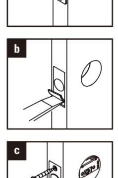
À l'aide d'un ciseau à bois, enlevez une couche de 4 mm (5/32 po) d'épaisseur à l'intérieur des contours tracés de sorte que la tête soit alignée avec le bord de la porte. Remarque : Il n'est pas nécessaire d'enlever une partie du bord de la porte afin d'y installer la tête de la serrure si vous utilisez un verrou à enfoncement.
