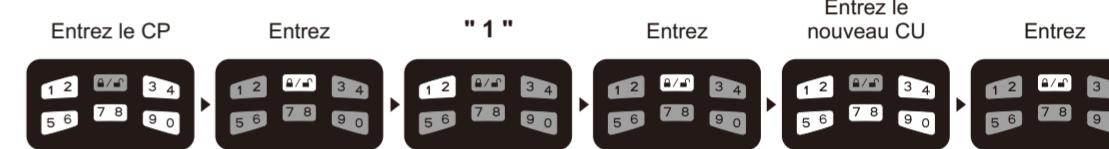
Remarque : Jusqu'à 20 codes d'utilisateur peuvent être sauvegardés. La longueur des codes d'utilisateur doit être de 4 à 10 chiffres.
