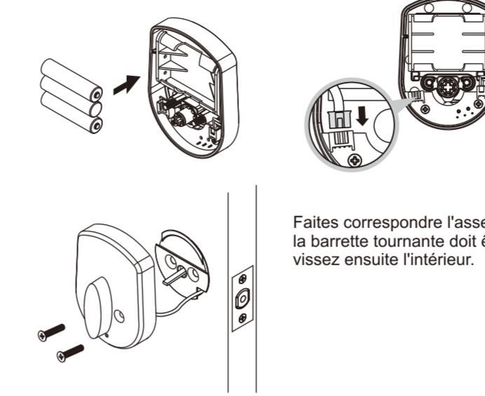
Faites correspondre l'assemblage intérieur, la barrette tournante doit être à la verticale; vissez ensuite l'intérieur.
