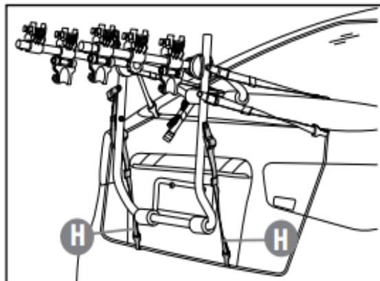
**Remarque :** Les crochets des sangles inférieures (H) peuvent également être accrochées sous le pare-chocs ou à la pièce de la structure métallique sous le véhicule.
