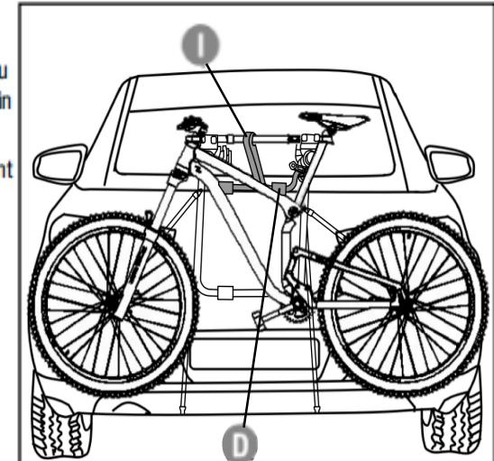
**Remarque :** Pour une sécurité maximale, il est recommandé de faire un simple noeud au niveau de la sangle de chargement avec boucle à came de 80 po (2 m) (bleu) (I).
