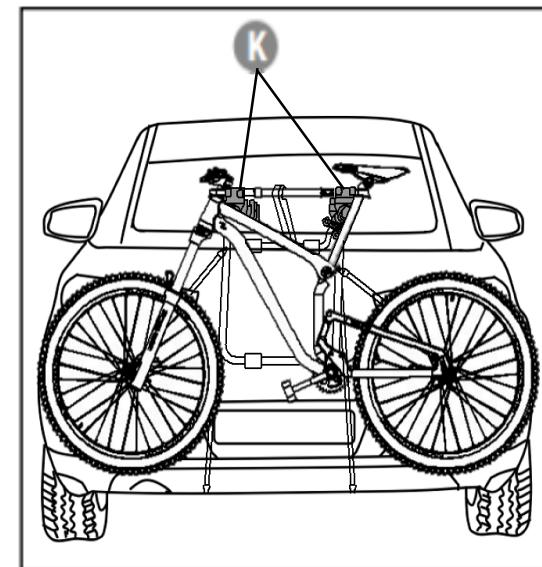
**Remarque :** Ajustez le berceau de vélo et la cage anti-oscillation (1) en fonction de la forme du vélo. Les berceaux peuvent être tournés et déplacés vers le haut/bas par rapport au bras du porte-vélo.
