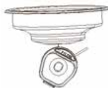
Nettoyer les filtres à boules avec une épingle plus fine
