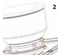
Fig. 2: Alignez les positions dans les cercles rouges de la figure, et appuyez dessus, faites pivoter dans le sens des aiguilles d'une montre et l'installer dans la machine.
