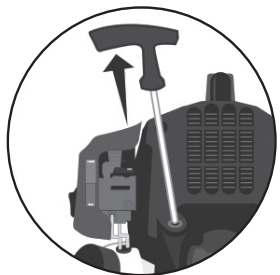
4. TIRER 3 à 5 FOIS Jusqu'à ce que le moteur commence à essayer de démarrer.
