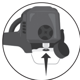
3. AMORCER LE MOTEUR 10 FOIS En appuyant sur la poire d'amorçage à côté du capuchon de réservoir à essence.
