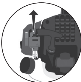
2. DÉPLACER L'ÉTRANGLEUR En déplaçant le levier d'amorçage vers le haut à la position START.
