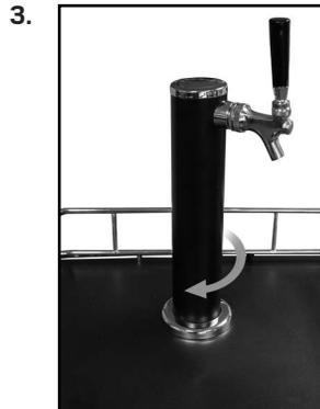
Aligner les encoches situées au bas de la tour avec le trou situé en haut de l'armoire, puis insérer et tourner la tour dans le sens des aiguilles d'une montre pour la verrouiller en place (environ un quart de tour).
