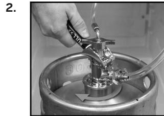
Faire tourner le coupleur dans le sens des aiguilles d'une montre jusqu'à ce qu'il se verrouille correctement.
