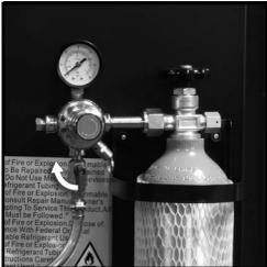
Une fois la pression désirée atteinte, serrer la bague de verrouillage intérieure. Tirer sur la soupape de Sécurité pour assurer le réglage correct. Si nécessaire, réajuster vos réglages.
