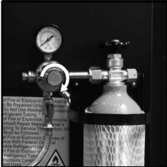
Tourner lentement le sélecteur de pression jusqu'à la valeur négative (-), puis tirer sur la soupape de surpression (PRV) pour obtenir une lecture précise. Ensuite tourner le cadran de la pression très lentement dans le sens horaire jusqu'à ce que la pression désirée soit affichée sur le manomètre de sortie (il est recommandé de 8 à 12 lb/po<sup>2</sup>).
