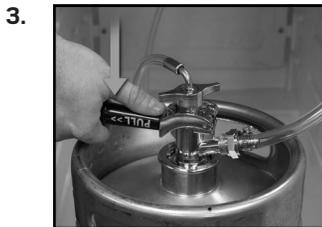
S'assurer que le robinet de la tour est dans la position fermée (la poignée pointée vers le haut). Sécuriser la connexion en tirant sur la poignée du coupleur et en poussant vers le bas jusqu'à ce qu'elle se verrouille en place. La poignée de traction "cliquera" quand elle passera dans la position finale vers le bas. Cela ouvrira les vannes de bière et de gaz CO<sub>2</sub>. Le fût est maintenant percé et exploité.
