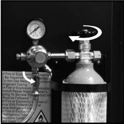
Fermer la vanne d'arrêt du régulateur et ouvrir complètement la vanne du réservoir de CO<sub>2</sub> en la tournant dans le sens contraire des aiguilles d'une montre.
