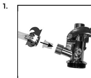
Si elle n'est pas déjà insérée, insérer la rondelle directionnelle CO<sub>2</sub> dans le coupleur de fût. Ensuite, visser la conduite de CO<sub>2</sub> sur le coupleur de fût.
