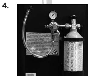
Placer le réservoir de CO<sub>2</sub> dans le porte-réservoir de CO<sub>2</sub>.
