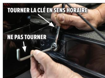
**MISE EN GARDE :** Un serrage exagéré de l'écrou Nutsert peut entraîner l'arrachement de ses filets et le rendre inutilisable.
