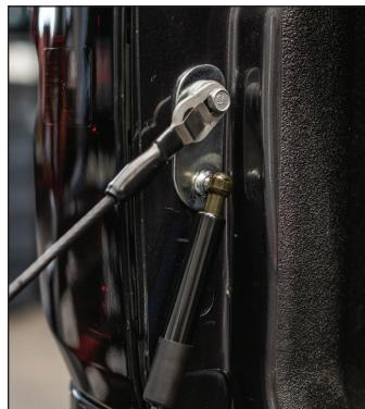
Installer l'extrémité étroite de l'amortisseur sur la plaque de montage à bille inférieure.
