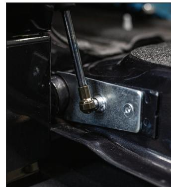
Examiner périodiquement les points de montage supérieur et inférieur afin de s'assurer que les pièces ne se sont pas desserrées au fil des ouvertures et fermetures répétées du hayon. Si l'un ou l'autre des points de montage semble lâche, resserrer la quincaillerie au besoin.
