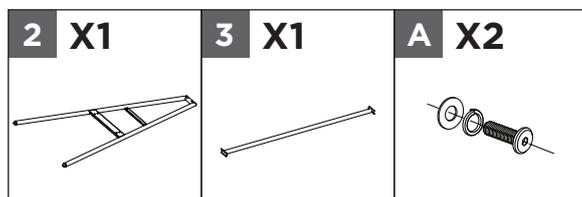
Fixez cadre de support **3** à la patte de table **2** au moyen des vis **A** avec des rondelles élastiques et des rondelles, en alignant les trous.
