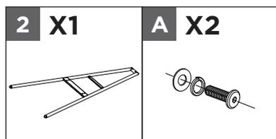
Connectez la patte de table **2** au cadre assemblé au moyen des vis **A** avec rondelles élastiques et rondelles, tout en alignant les trous.
