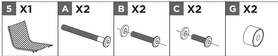
Connectez le panneau de siège **5** au cadre assemblé au moyen des vis **B** avec les rondelles et les entretoises **G**, puis au moyen des vis **C** avec des rondelles, enfin avec les vis **A**, en alignant les trous.
