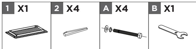
Fixez chaque patte de table **2** au dessus de table **1** au moyen des vis **A** avec des rondelles élastiques et des rondelles, en alignant les trous.
