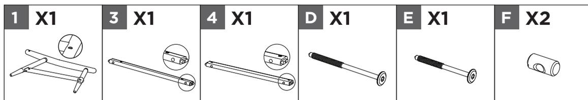
Fixez l'accoudoir droit **1** au panneau inférieur **3** et **4** au moyen de l'écrou à barillet **F** et des vis **D** et **E** en alignant les trous.
