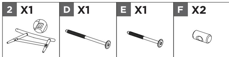
Connectez l'accoudoir gauche **2** au cadre assemblé au moyen de l'écrou à barillet **F**, des vis **D** et **E**, en alignant les trous.
