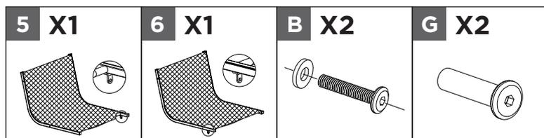
Fixez le panneau de siège **5** au panneau de siège **6** au moyen des vis **B** avec rondelles et des écrous manchons **G**, en alignant les trous.
