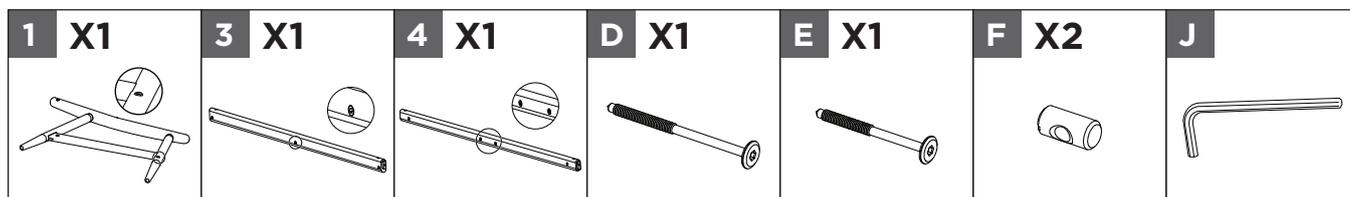
Fixez l'accoudoir droit **1** au panneau inférieur **3** et **4** au moyen de l'écrou à barillet **F** et des vis **D** et **E** en alignant les trous.
