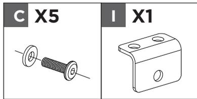
Connectez en utilisant les vis **C** avec rondelles et le support en **I**, en alignant les trous.
