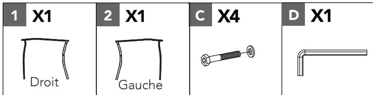
Alignez les trous de boulons sur l'accoudoir droit (1) avec les trous de boulons correspondants sur le cadre arrière (6) et insérez les boulons M6x55L combinés avec les rondelles (C). Répétez l'étape pour les autres trous et l'accoudoir gauche (2). Serrez les boulons à l'aide de la clé hexagonale (D).
