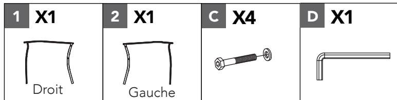
Alignez les trous de boulons sur l'accoudoir droit (1) avec les trous de boulons correspondants sur le cadre arrière et insérez les boulons M6x55L combinés avec les rondelles (C). Répétez l'étape pour les autres trous et l'accoudoir gauche (2). Serrez les boulons à l'aide de la clé hexagonale (D).
