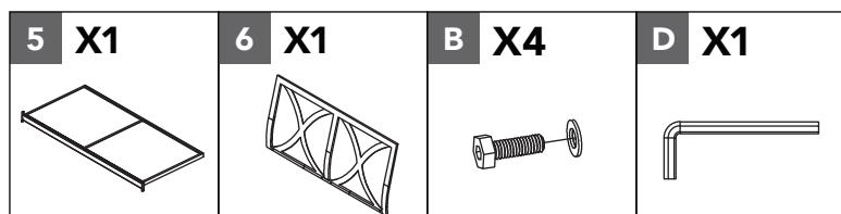
Fixez le dossier de la causeuse (6) au siège de la causeuse (5) au moyen des boulons M6x25L combinés avec rondelles (B), en alignant les trous. Ne serrez pas à fond.
