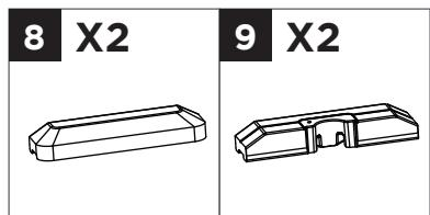
Ouvrez les bases latérales **8** et les bases de milieu **9** en tournant les fiches dans le sens horaire. Versez du sable ou du calcaire dans les bases latérales **8** et les bases de milieu **9**. Fermez les bases latérales **8** et les bases de milieu **9** en tournant les bouchons dans le sens horaire.
