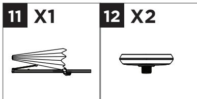
Fixez les panneaux solaires **12** au parasol **11** en tournant les panneaux solaires **12** dans le sens horaire jusqu'à ce qu'ils soient complètement serrés.
