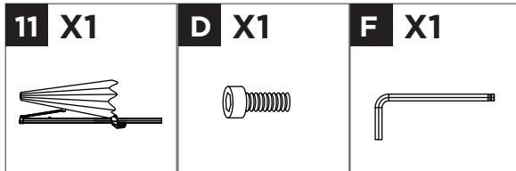
Raccordez le parasol **11** au tube du socle **3** au moyen des boulons M6x15 **D** et de la clé hexagonale M6 **F**.
