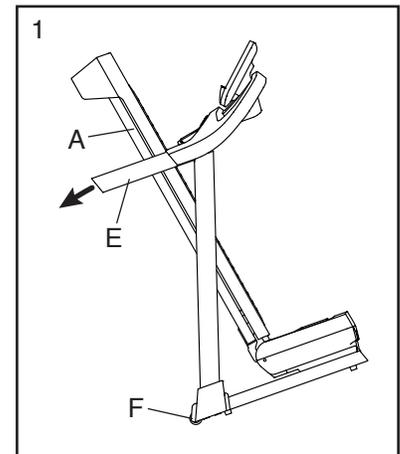
2. Faites basculer la rampe (E) vers l'arrière jusqu'à ce que le tapis de course repose sur les roues (F), puis déplacez l'appareil jusqu'à l'emplacement voulu. **MISE EN GARDE : ne déplacez pas le tapis de course sans l'avoir fait basculer vers l'arrière, ne tirez pas sur le cadre (A) et ne déplacez pas l'appareil sur une surface irrégulière.**
