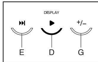
**Scan mode (mode balayage)** – La console comporte également un mode balayage qui affichera en boucle des informations sur l'entraînement. **Pour activer le mode balayage**, appuyez sur la touche Scan (balayage) (E); l'indicateur de balayage (F) et le mot SCAN s'afficheront à l'écran.
