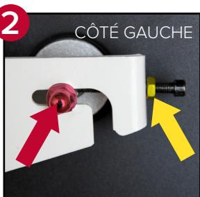
**ÉTAPE 2 :** À l'aide de la clé multiusage ou d'une clé à douilles (non fournie), desserrez les écrous d'essieu (indiqués par des flèches rouges) sur le côté droit et le côté gauche de la roue d'inertie. À l'aide de la clé multiusage, dévissez les contre-écrous d'ajustement (indiqués par des flèches jaunes) sur les deux côtés de la roue d'inertie.
