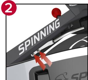
**ÉTAPE 2 :** À l'aide d'une clé Allen de 4 mm, retirez soigneusement les deux écrous qui soutiennent les plaquettes de frein (indiqué par des flèches rouges). Retirez l'ancien ensemble de plaquettes de frein.
