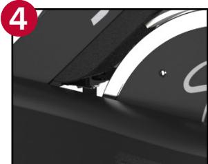
**ÉTAPE 4 :** Tout en ajustant la tension de la chaîne, travailler sur les deux côtés de la roue d'inertie. Ajustez l'angle de la roue d'inertie afin qu'elle soit alignée (de l'avant à l'arrière) et espacée uniformément entre les fourches (gauche à droite).
