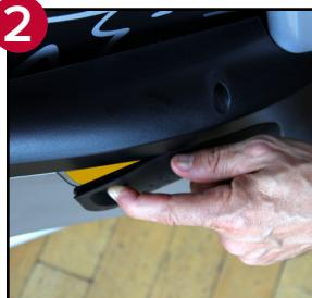
**ÉTAPE 2 :** Avec les doigts, retirez délicatement le couvercle de l'ajustement de la roue d'inertie du garde-chaîne. Vous exposerez ainsi une petite section de la chaîne près du pignon avant.
