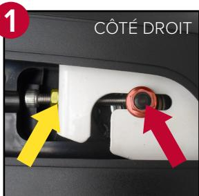
**ÉTAPE 1 :** Pour accéder à l'écrou d'essieu sur le côté droit du cardiovélo Spinner<sup>MD</sup>, vous devrez d'abord retirer le petit couvercle en caoutchouc d'ajustement de la roue d'inertie. Veuillez consulter l'étape 2 de la section précédente.
