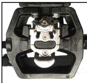
Les pédales SPD sont réglées à la tension de déblocage la plus faible en usine par mesure de sécurité. Si vous souhaitez augmenter la tension, utilisez une clé Allen de 3 mm et tournez la vis de réglage dans le sens horaire. Réglez les côtés gauche et droit de manière égale et commencez par un réglage aussi faible que nécessaire jusqu'à ce que vous obteniez la tension de relâchement souhaitée.
