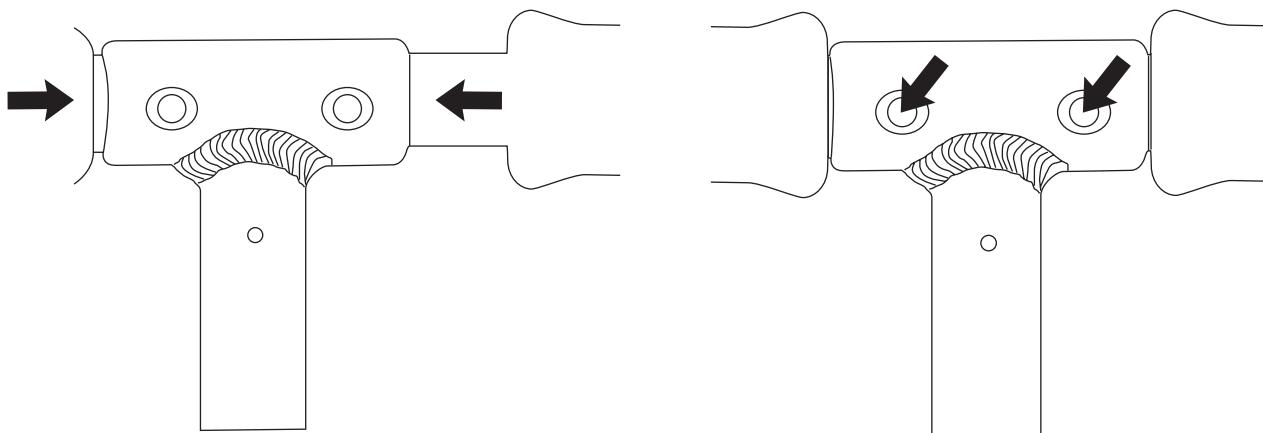
Veuillez vous assurer que les goupilles du guidon sont verrouillées. Rouler avec les pouces sur les goupilles peut provoquer le détachement du guidon.
