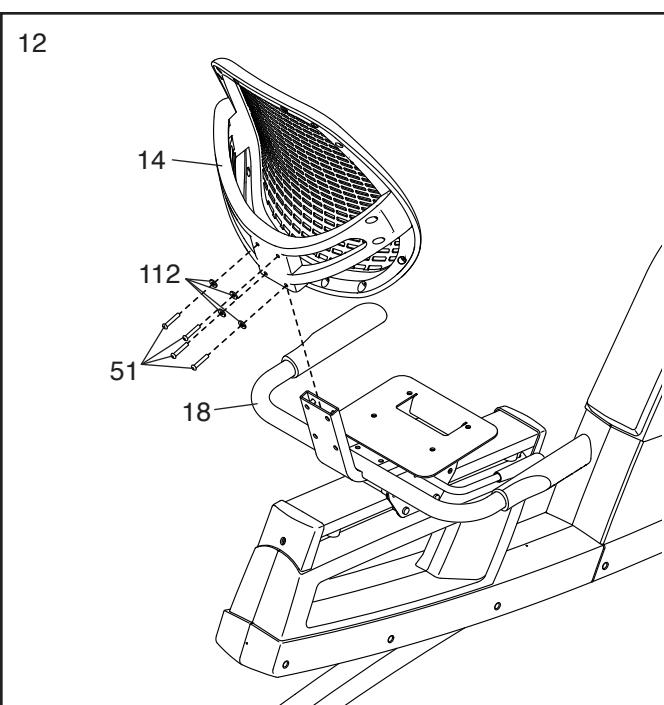
13. Attachez le Siège (12) au Guidon du Siège (18) à l'aide de quatre Vis M6 x 20mm (67) et quatre Rondelles M6 (112) (seules deux de chacune d'elles sont illustrées) ; **engagez d'abord toutes les Vis, et serrez-les ensuite.**
