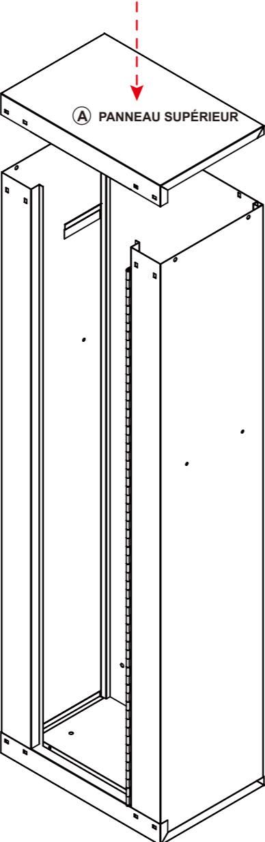
Une fois les panneaux latéraux et arrière installés, ceux-ci peuvent être insérés dans la partie intérieure du panneau supérieur. Veuillez vous référer au panneau inférieur pour la mise en place. Quelques légers coups de maillet en cuir peuvent être utiles pour aligner avec précision le panneau supérieur avec les panneaux latéraux et arrière.
