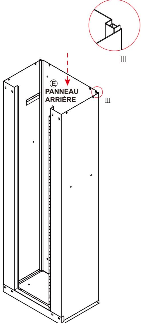
Comme illustré, insérer le panneau arrière entre les deux panneaux latéraux jusqu'à ce que le dessus soit aligné.
