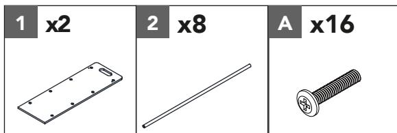
Fixez huit tubes métalliques (2) aux panneaux latéraux (1) au moyen de seize boulons (A).
