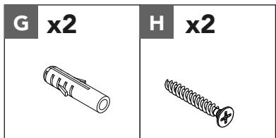
Fixez le produit au mur au moyen de deux chevilles d'ancrage murales (G) et de deux vis (H).
