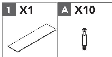
Insérez dix boulons à came (A) dans le panneau supérieur (1). Serrez tous les boulons à came.
