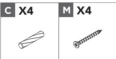
Insérez quatre goujons de bois (**C**) dans les cloisons (**3**). Fixez le panneau inférieur (**7**) aux cloisons (**3**).
