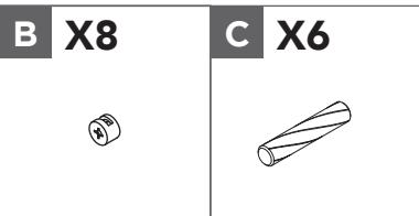
Insérez six goujons de bois (**C**) dans les tabliers supérieurs (**5**), les traverses arrière (**6**), le panneau inférieur (**7**) et les tabliers inférieurs (**10**). Fixez le panneau de gauche (**2**) aux tabliers (**5**), aux traverses arrière (**6**) et au panneau inférieur (**7**).
