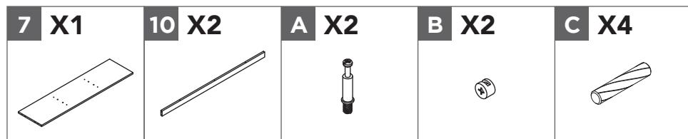
Insérez deux boulons à came (**A**) et quatre goujons de bois (**C**) dans le panneau inférieur (**7**). Fixez deux tabliers inférieurs (**10**) au panneau inférieur (**7**). Insérez deux cames (**B**) dans les tabliers inférieurs (**10**). Serrez toutes les cames.
