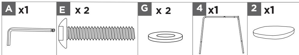
Fixez la patte en métal supérieure (4) au siège (2) au moyen de deux rondelles (G) et deux boulons (E). Serrez avec la clé hexagonale (A), mais ne serrez pas complètement.
