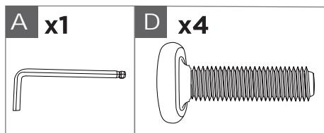
Fixez le cadre du repose-pieds (6) aux pattes au moyen de quatre boulons (D). Serrez avec la clé hexagonale (A), mais ne serrez pas complètement
