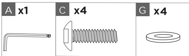
Fixez le dossier (1) au cadre arrière (3) au moyen de quatre rondelles (G) et quatre boulons (C). Serrez le tout avec la clé hexagonale (A). Serrez complètement tous les boulons. L'assemblage est terminé.
