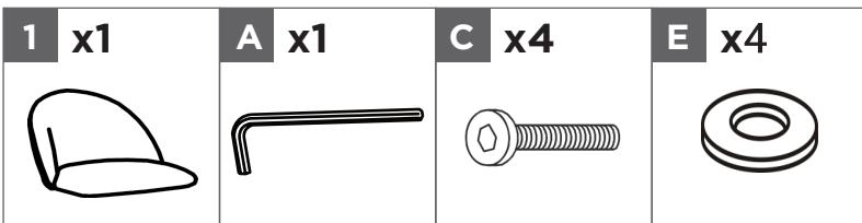
Fixez la base métallique au siège 1 au moyen des boulons C et des rondelles E comme indiqué.
