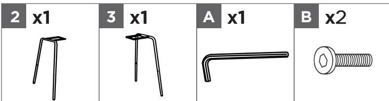
Fixez la patte gauche **3** à la patte de droite **2** au moyen des boulons **B** comme indiqué. Les boulons doivent d'abord traverser les trous de la patte de gauche **3**, puis se visser dans les trous filetés de la patte de droite **2**. Ne serrez pas complètement les boulons à cette étape.
