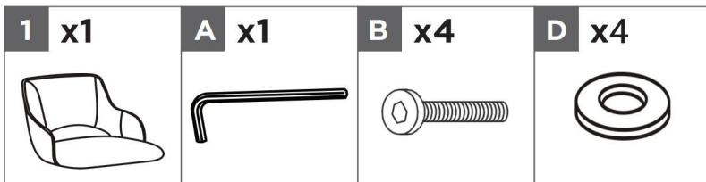
Fixez la base métallique au siège 1 au moyen des boulons B et des rondelles D comme indiqué.
