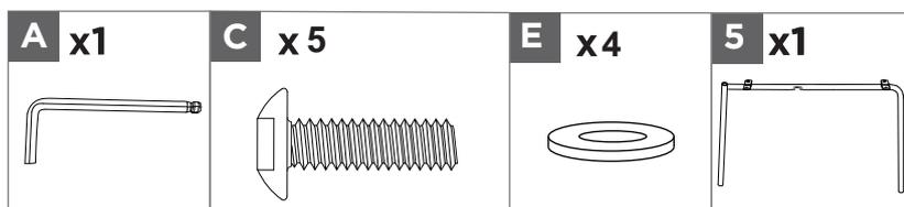
Fixez la patte en métal inférieure (5) au siège (2) au moyen de quatre rondelles (E) et cinq boulons (C). Serrez avec la clé hexagonale (A), mais ne serrez pas complètement.
