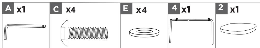
Fixez la patte en métal supérieure (4) au siège (2) au moyen de quatre rondelles (E) et quatre boulons (C). Serrez avec la clé hexagonale (A), mais ne serrez pas complètement.
