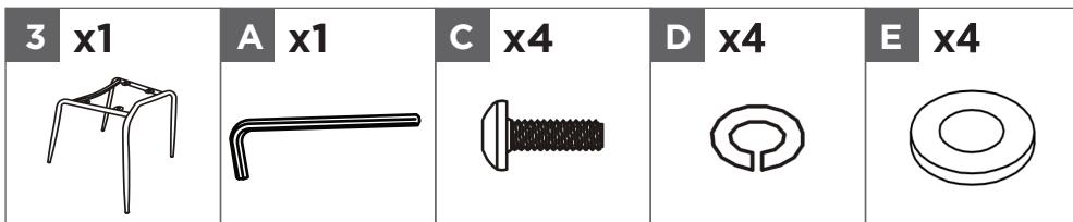
Fixez la patte **3** au siège **2** au moyen des boulons **C**, des rondelles frein **D** et des rondelles plates **E** comme indiqué.
