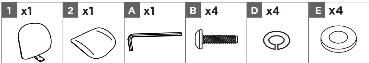
Fixez le dossier **1** au siège **2** au moyen des boulons **B**, des rondelles frein **D** et des rondelles plates **E**.
