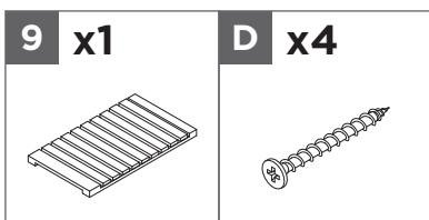
Insérez quatre vis M4x40 **D** à travers le cadre de patte gauche **5** et le cadre de patte droit **6** dans la tablette **9**. Serrez toutes les vis.
