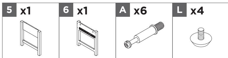
Insérez six boulons à came **A** dans le cadre de patte gauche **5** et le cadre de patte droite **6**.
