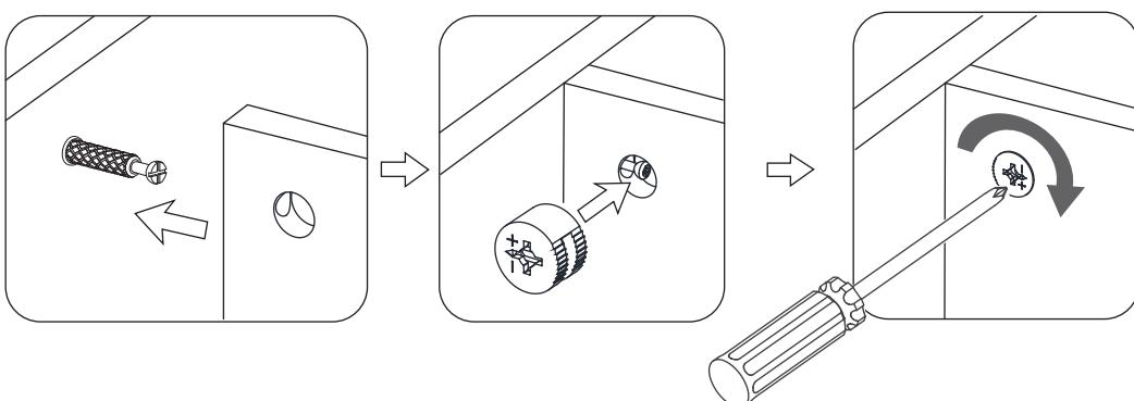
1. Vissez le boulon à came dans les petits trous prépercés du panneau. Alignez les panneaux à joindre de sorte que le boulon à came pénètre dans le trou prépercé sur le bord du deuxième panneau et dépasse dans le trou qui abritera le verrou à came.
