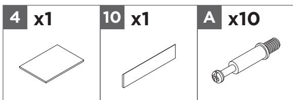
Insérez dix boulons à came **A** dans le dessus du banc **4** et la devanture **10**. Serrez tous les boulons à came.
