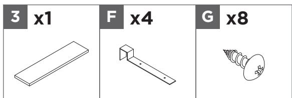
Insérez huit vis M4x16 **G** à travers quatre porte-tablette **F** dans la tablette réglable **3**. Serrez toutes les vis.
