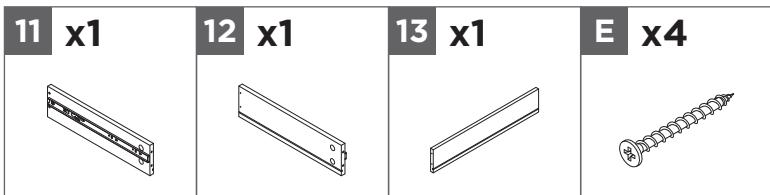
Insérez quatre vis E à travers le côté gauche du tiroir **11** et le côté droit du tiroir **12** dans le dos du tiroir **13**. Serrez toutes les vis.
