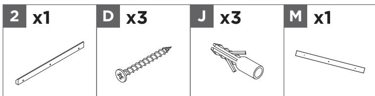
Collez le gabarit mural M sur le mur en vous assurant qu'il est de niveau. Percez un trou à chaque marque sur le gabarit, martelez trois chevilles d'ancrage murales J dans le mur, et fixer le rail de montage mural **2** au moyen de trois vis M4x40 **D** vissées dans les chevilles d'ancrage murales **J**.
