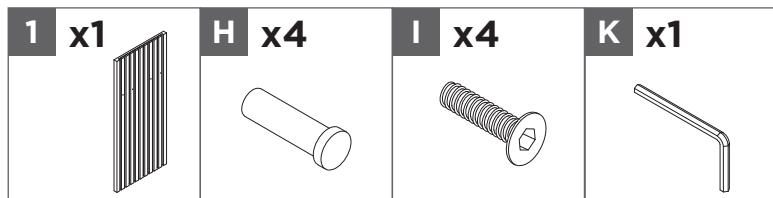
Insérez quatre boulons M8x25 **I** à travers le panneau arrière **1** dans les crochets **H**. Serrez tous les boulons à l'aide de la clé hexagonale **K**.
