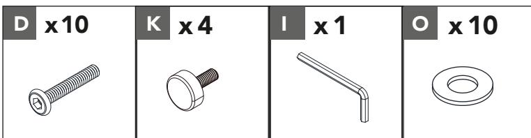
Alignez le cadre métallique assemblé avec les trous sur le panneau inférieur **4**. Fixez le tout avec 10 boulons **D** à 10 rondelles **O**. Utilisez la clé hexagonale **I** pour serrer les boulons. Fixez les 4 pieds de nivellation **K** aux extrémités des pattes métalliques **7**.
