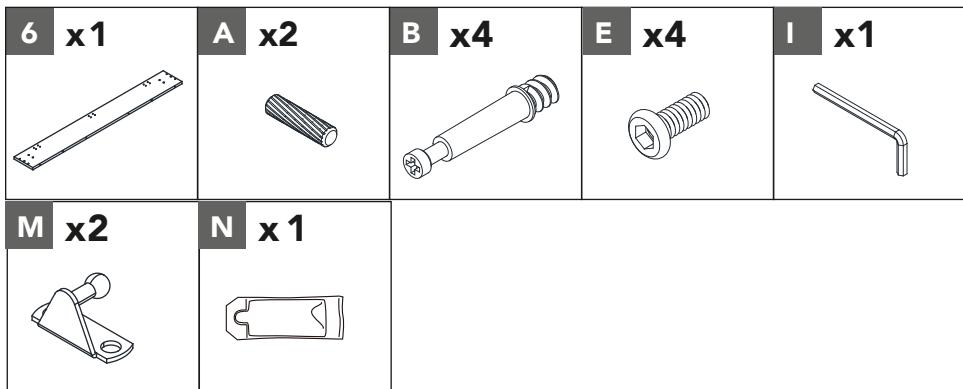
Insérez 2 goujons de bois **A** et 4 boulons à came **B** dans le panneau arrière **6**. Fixez 2 connecteurs à vérin à gaz **M** dans le panneau arrière **6** au moyen de 4 boulons **E**.
