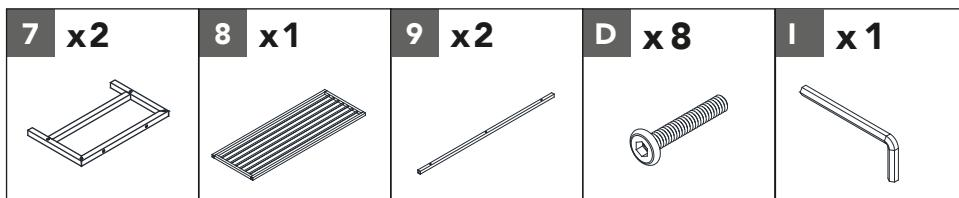
Alignez la tablette en métal **8** et deux rails de support métalliques **9** avec les trous sur les deux pieds métalliques **7**. Fixez-les au moyen de 8 boulons **D**. Utilisez la clé hexagonale **I** pour serrer les boulons.
