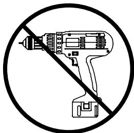
**REMARQUE :** Une perceuse n'est pas recommandée; faites attention à l'excès de perçage afin d'éviter les dommages.
