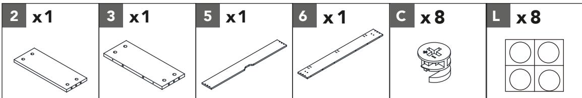
Connectez le panneau avant **5** et le panneau arrière **6** avec le panneau latéral de gauche **2** et le panneau latéral de droite **3** au moyen de 8 cames **C**. Couvrez les trous de came dans les panneaux latéraux avec des autocollants **L**.
