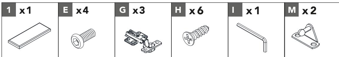
Alignez 3 charnières **G** avec les trous sur le panneau de siège **1**. Fixez le tout avec 6 vis **H**. Fixez 2 connecteurs à vérin à gaz **M** au panneau de siège **1** au moyen de 4 boulons **E**. Serrez le tout avec la clé hexagonale **I**.
