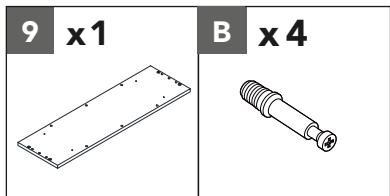
Insérez quatre boulons à came (B) dans la tablette fixe (9).
