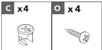
Insérez quatre cames (C) dans les trous du panneau inférieur gauche (13) et du panneau inférieur droit (14).
