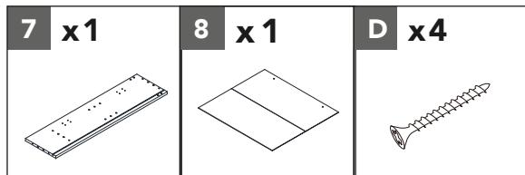
Insérez le panneau supérieur du dos (8) dans les rainures de la tablette fixe (5) et du haut (4). Fixez le panneau latéral supérieur gauche (7) au boîtier assemblé avec quatre vis (D).
