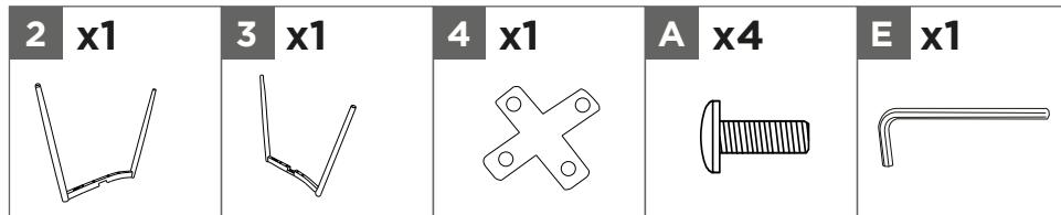
Joignez le pied métallique **2** au pied métallique **3**. Alignez les trous de la plaque métallique **4** avec les trous sous les pieds métalliques **2** et **3** et fixez l'ensemble au moyen des vis **A** à l'aide de la clé hexagonale **E**.
