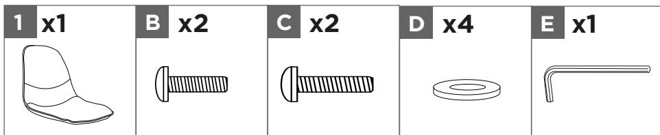
Fixez les pieds au siège 1. Pour ce faire, alignez les trous des pieds métalliques 2 et 3 avec la base du siège 1 et fixez-les au moyen des vis B et C et de la rondelle D et serrez à l'aide de la clé hexagonale C.
