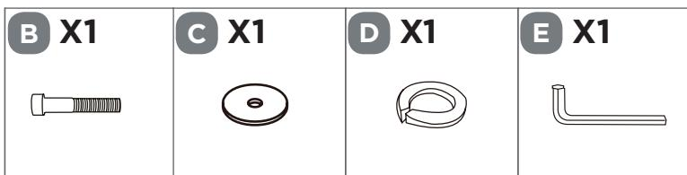
Fixez le SIÈGE (1) au milieu du DOSSIER (2) au moyen d'une vis M8x60 mm (B) à l'aide de la CLÉ HEXAGONALE (E). Ne serrez PAS la vis.
