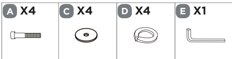
Terminez l'assemblage du SIÈGE (1) au DOSSIER (2) au moyen des VIS M8x85 mm (A), des RONDELLES (C) et des ÉCROUS DE BLOCAGE (D) à l'aide de la CLÉ HEXAGONALE (E). Serrez les fixations d'environ 80 %.
