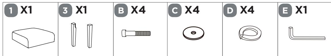
Fixez les PATTES (3) au SIÈGE (1) au moyen de quatre VIS M8x60 mm (B) à l'aide de la CLÉ HEXAGONALE (E). Serrez à la main à environ 80 %.
