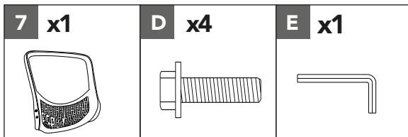
Fixez le coussin de dossier (7) aux accoudoirs (8) au moyen des boulons (D). Serrez les boulons à 80 % à l'aide de la clé hexagonale (E). NE SERREZ PAS à fond.
