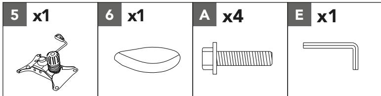
Fixez la plaque du siège (5) à la base du coussin du siège (6) au moyen des boulons (A) à l'aide de la clé hexagonale (E).
