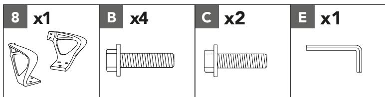
Fixez les accoudoirs (8) de chaque côté du coussin de siège (6) au moyen des boulons (B) et (C). Serrez les boulons à 80 % à l'aide de la clé hexagonale (E). NE SERREZ PAS à fond.
