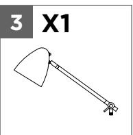
Retirez l'excédent de cordon de la base **1**, puis insérez et vissez l'ensemble du bras **3** sur le tube **2** (**d**) en le tournant dans le sens horaire jusqu'à ce qu'il soit bien fixé.
