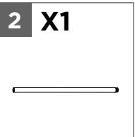
Insérez et vissez le tube **2 (c)** dans le tube **2 (b)** en le tournant dans le sens horaire jusqu'à ce qu'il soit bien fixé.
