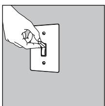
2) Selon le type de boîte à fusibles dans votre maison : vous pouvez soit mettre l'interrupteur principal (général) en position d'arrêt (OFF) afin de couper l'alimentation à toute la maison, soit éteindre l'interrupteur individuel qui alimente l'endroit où le luminaire doit être installé.
