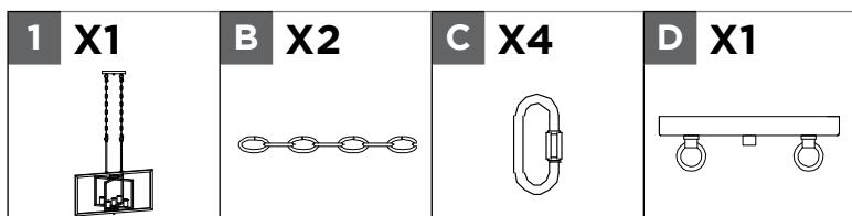
Fixez les chaînes **B** sur le luminaire **1** à l'aide des mousquetons **C** situés au bas de chaque chaîne. Passez les câbles à travers les maillons de la chaîne.
