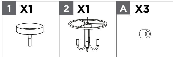
Alignez les trous du luminaire **2** sur les bras métalliques **4** et fixez-les en place à l'aide d'écrous décoratifs **A**. Alignez le couvercle **1** sur la tige filetée du luminaire **2** et verrouillez-le en place.
