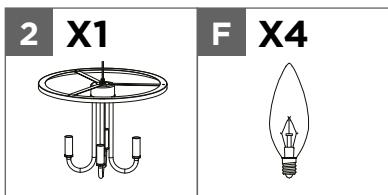
Installez quatre ampoules E12 candélabre de 40 W (non comprises) sur le luminaire **2**.
