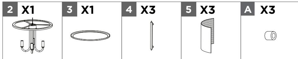
Placez les bras des clips métalliques **4** sur l'anneau métallique **3**, les clips métalliques **4** étant orientés vers l'intérieur, et fixez-les par le bas à l'aide des écrous décoratifs **A**. Placez délicatement les panneaux de verre **5**, un par un, sur l'anneau métallique **3** et dans les bras des clips métalliques **4**.
