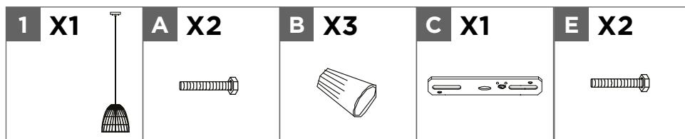
Fixez la bande de montage **C** avec les vis de montage **E** à la boîte de sortie en utilisant les vis de boîte de sortie **A** pour la fixer.
