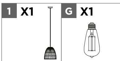
Vissez une ampoule **G** à culot moyen (E26) de 60 W maximum dans la douille du luminaire **1**.
