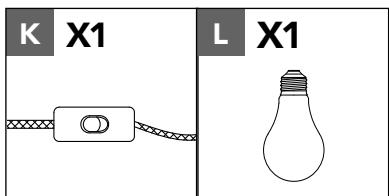
Insérez et vissez l'ampoule (**L**) dans la douille. Utilisez une ampoule à **culot moyen (E26) de 60 W maximum**.
