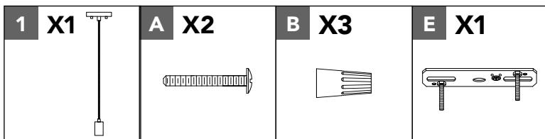
Fixez le support de montage (E) avec les vis de la boîte de sortie (A) à la boîte de sortie.
