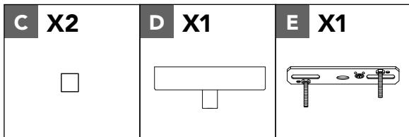
Alignez les trous de montage du couvercle (D) avec les vis de montage du support de montage (E).
