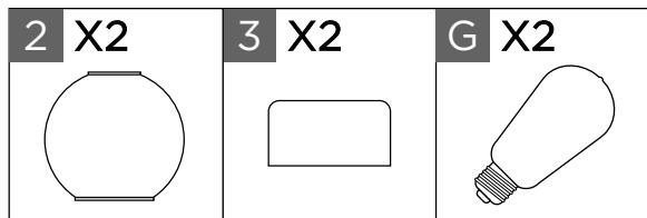
Glissez un diffuseur en verre **2** sur chaque douille sur le corps principal du luminaire **1**.
