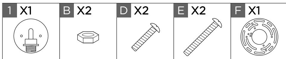
Enfilez les vis du luminaire **E** dans les trous prévus du support de montage **F**.
