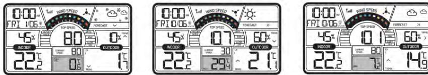
Température ressentie : est la température extérieure perçue. Si la température extérieure est inférieure à 50F / 10C, l'appareil mesure l'effet de la vitesse du vent. Le résultat est un effet de refroidissement éolien et qui sera représenté par la température ressentie extérieure.
