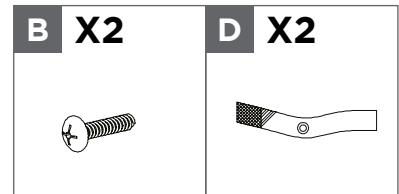
Fixez la sangle D au mur à l'aide du boulon B aux emplacements indiqués sur les montants ou sur le bois.
