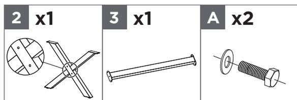
Fixez le cadre de patte gauche **2** au cadre de support **3** au moyen des vis **A** avec rondelles en alignant les trous.
