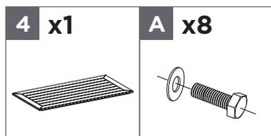
Connectez le dessus de table **4** au cadre assemblé au moyen des vis **A** avec rondelles, tout en alignant les trous.
