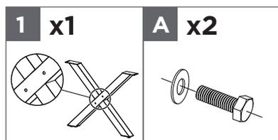
Connectez le cadre de patte droite **1** au cadre assemblé au moyen des vis **A** avec rondelles, en alignant les trous.
