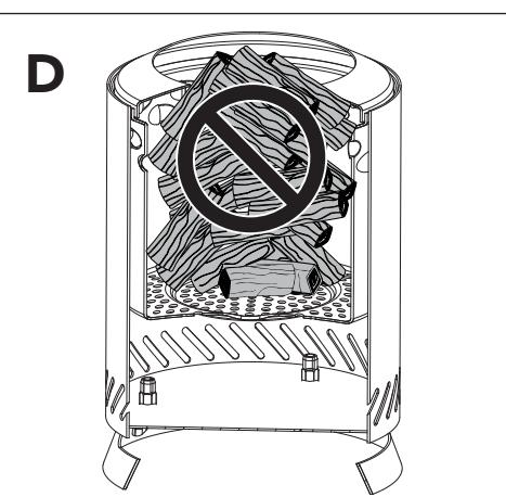
N'empilez jamais de bois plus haut que les trous de combustion intérieurs. Cela coupera le flux d'air et fera fumer votre feu. Assurez-vous que le bois repose sous les trous et qu'ils sont clairement visibles après le ravitaillement (voir l'illustration D).
