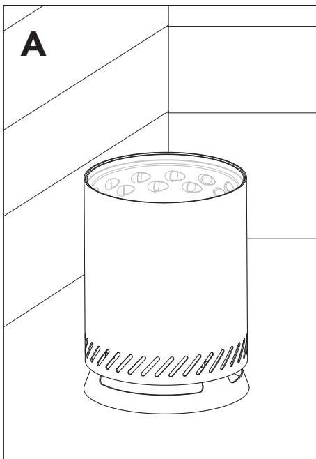
**Étape 1 :** Positionnez le foyer sur une surface plane. Si vous utilisez des granulés, insérez l'adaptateur de granulés (voir l'illustration A).
