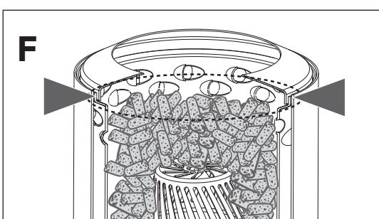
**Étape 2 :** Ajoutez des granulés à la chambre de combustion. Ne remplissez pas trop; les granulés ne doivent pas être plus hauts que les trous de combustion intérieurs (voir l'illustration F), car cela peut obstruer la circulation de l'air et provoquer la fumée du feu.
